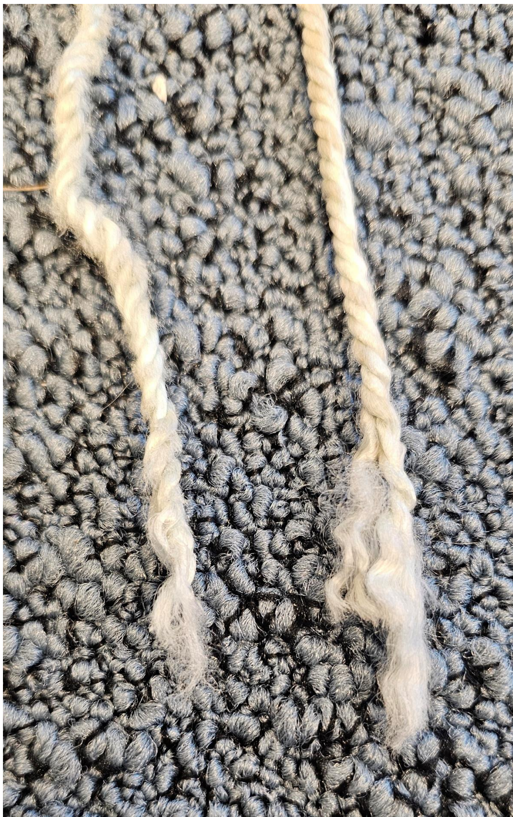
Bildene viser bruddstedet i de to kordellene som stikker ut fra bruddflaten på den korte delen av tauet. Den korte kordellen til venstre og den lange kordellen til høyre.
