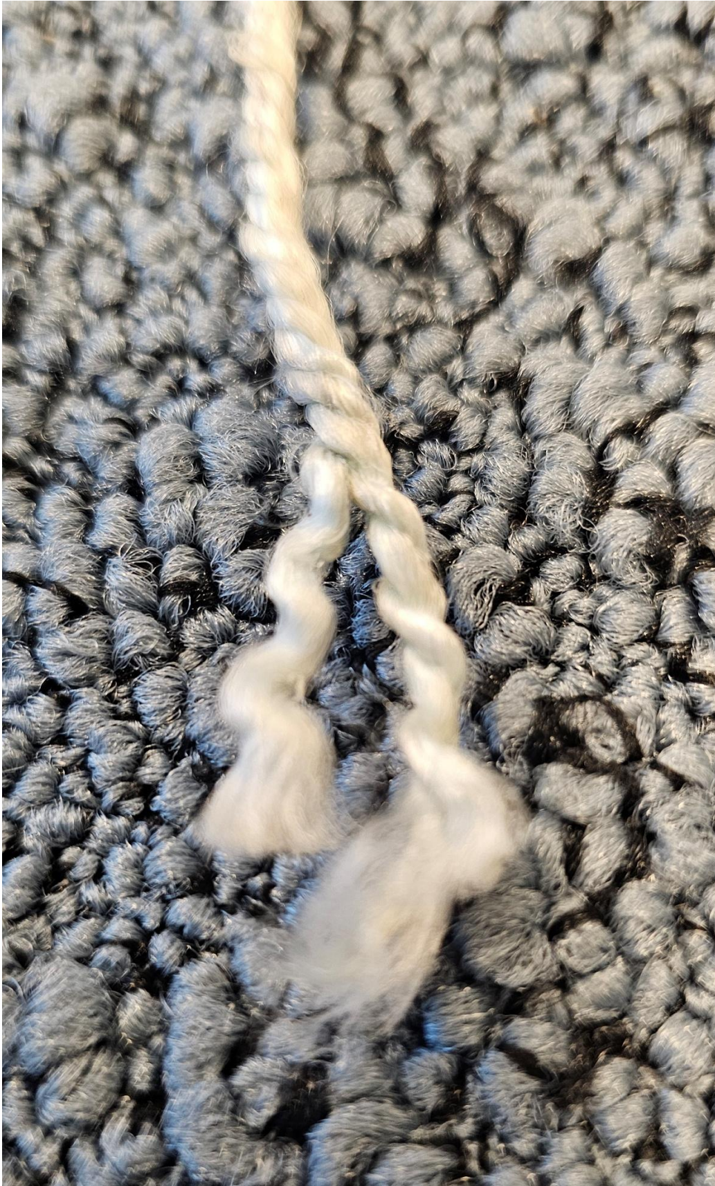
Nærbilde av bruddstedet på kordellen som stikker ut fra den lange delen av tauet.
