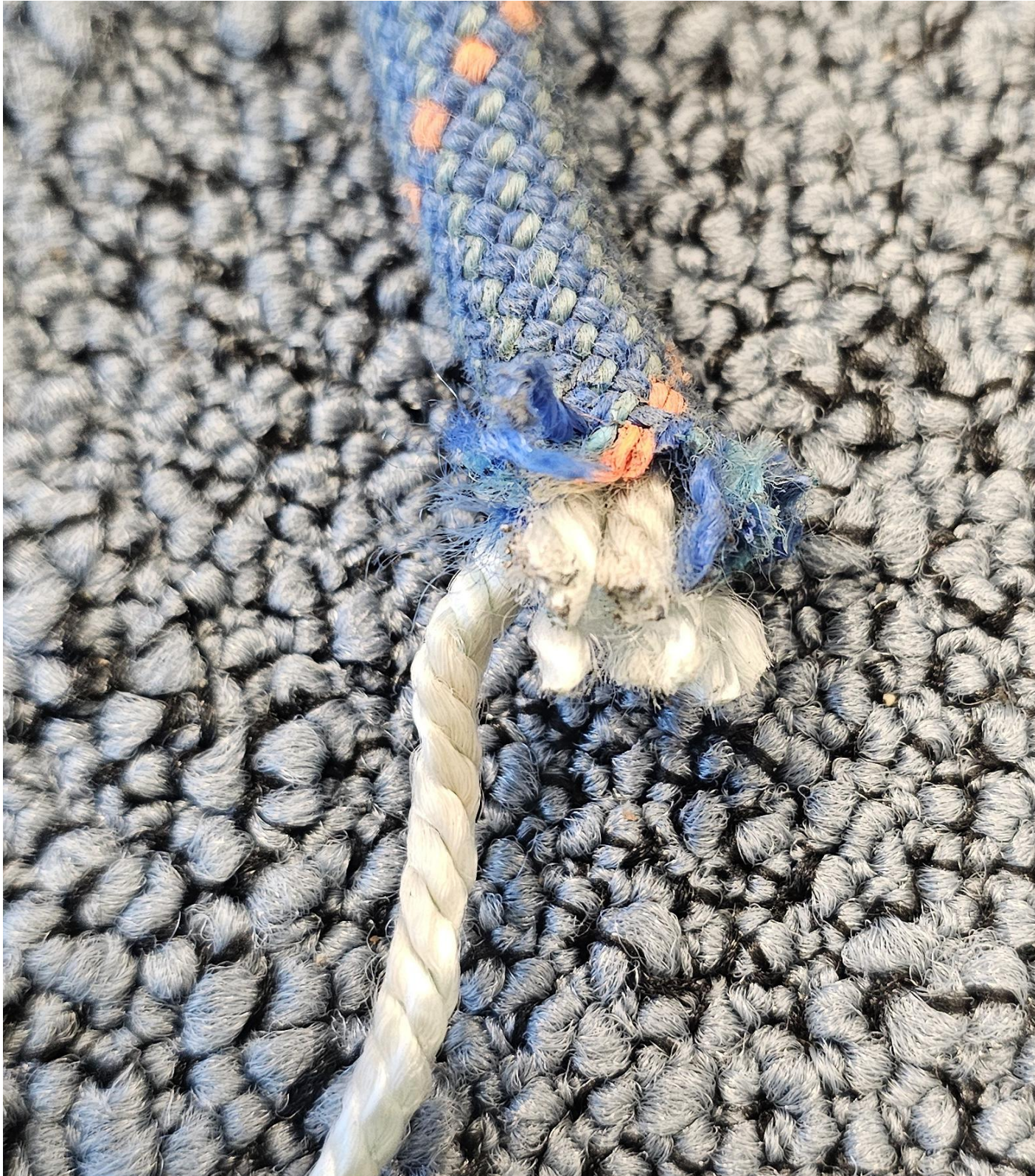
Nærbilde av bruddflaten på den lange delen av tauet.
