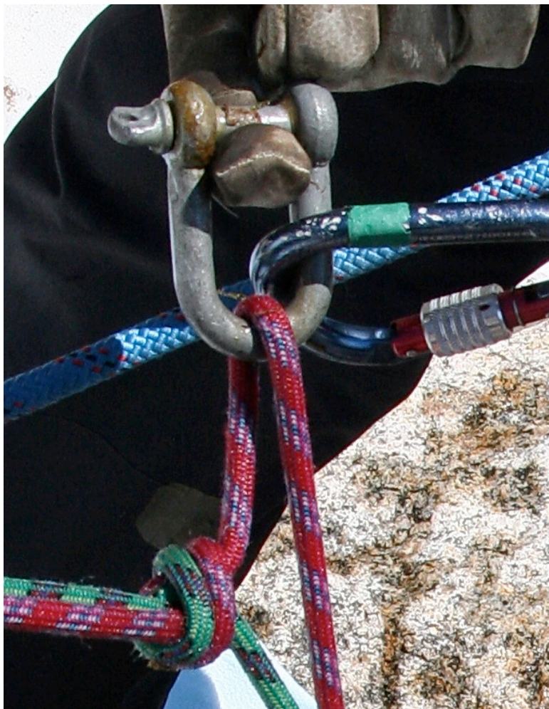
Bilde 8. Sjakkelen fra rappellfestet slik den ble funnet på rappeltauet.
