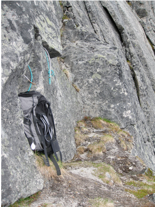
Bilde 5. Ulykkesstedet på undersøkelsesdagen: SHs sekk og rappellfestet med brudd på nylontau og stålvaier.
