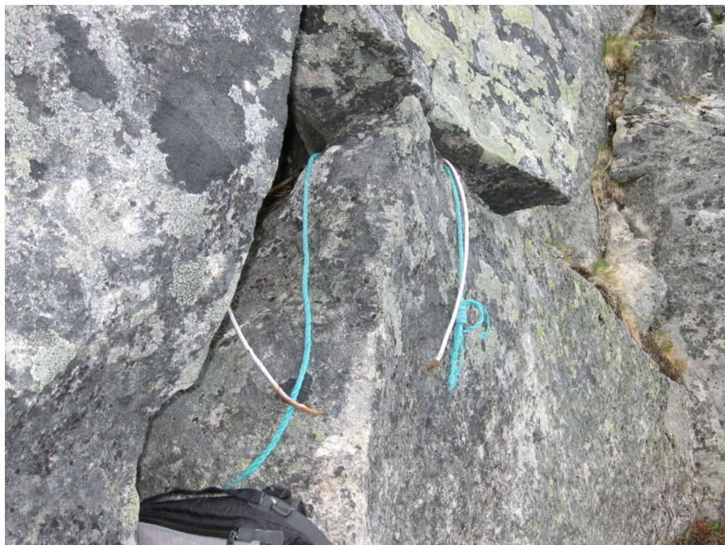
Bilde 6. Rappellfestet med bruddstedet. Både nylontauet (turkis) og den plastbelagte stålvaieren (hvit) har røket. Forlengeren opp til de to ekstra forankringene er skjult bak steinblokkene.
