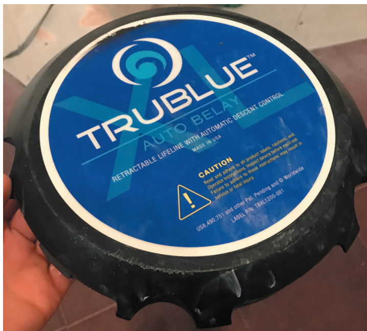
HENDELSE: Dette dekelet falt av da True Blue-maskinen fikk et smell i veggen under fall. Det falt av og kunne godt ha truffet klatrere der nede. Foto: Leiv Aspelund
